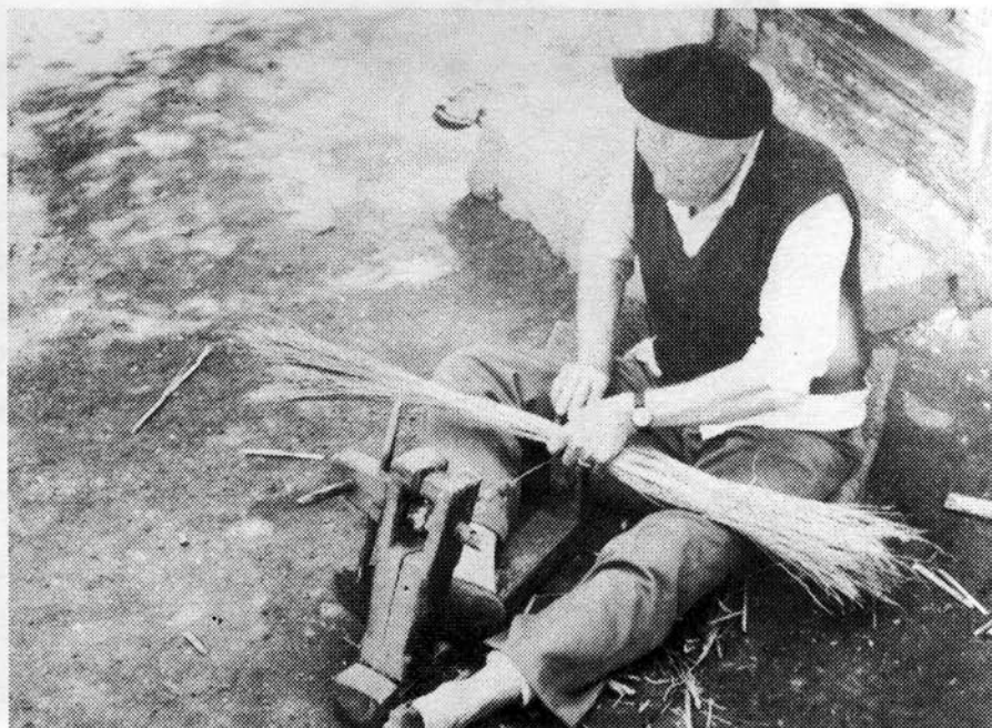
Sl. 27. »Uturivanje« metlike u »taslak« (četvrta faza u izradi metle)
